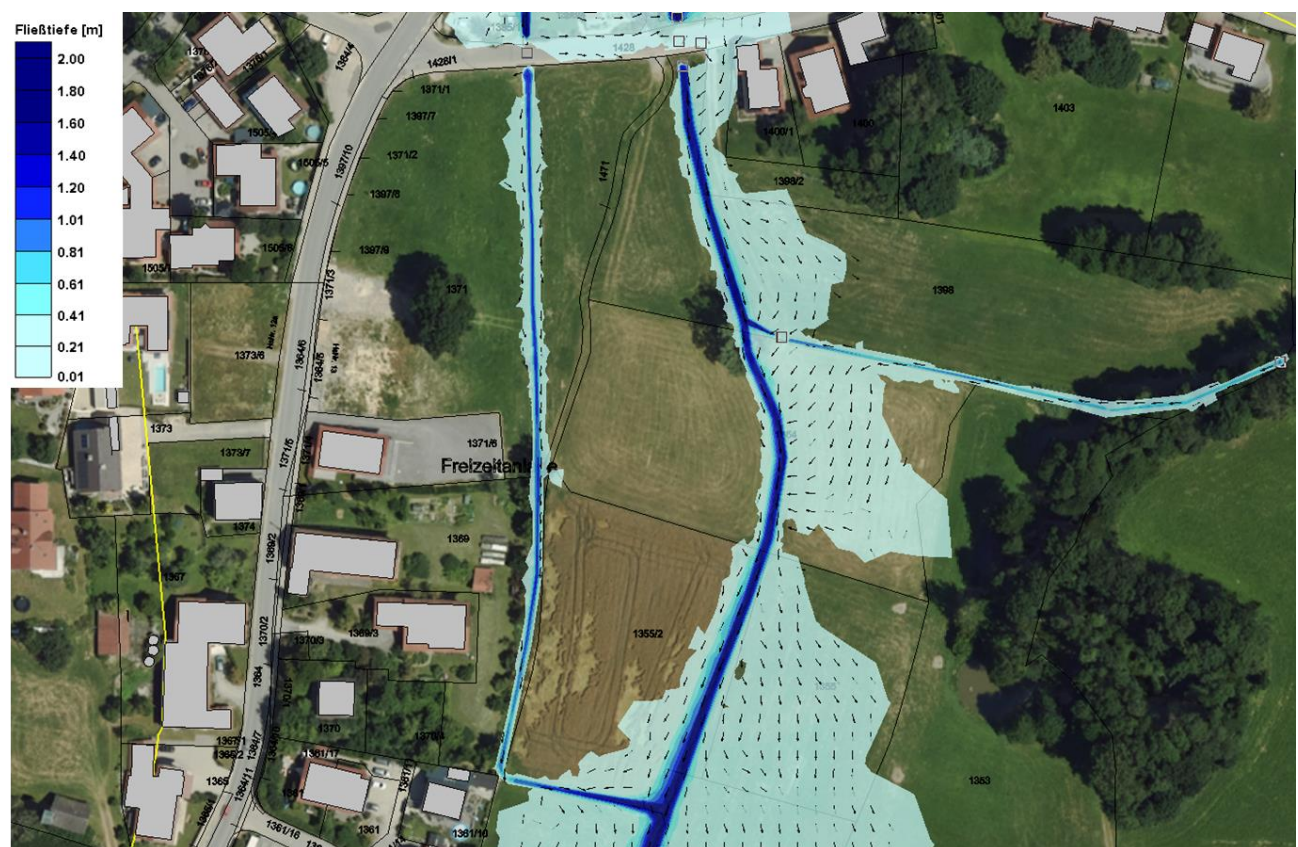
Abbildung 5.7: Abflusssituation im Ist-Zustand, HQ_{100} – Detailansicht Bauvorhaben
