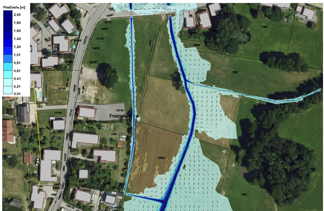
Abbildung 2.5: Abflusssituation im Ist-Zustand, HQ_{100} – Detailansicht Bauvorhaben
