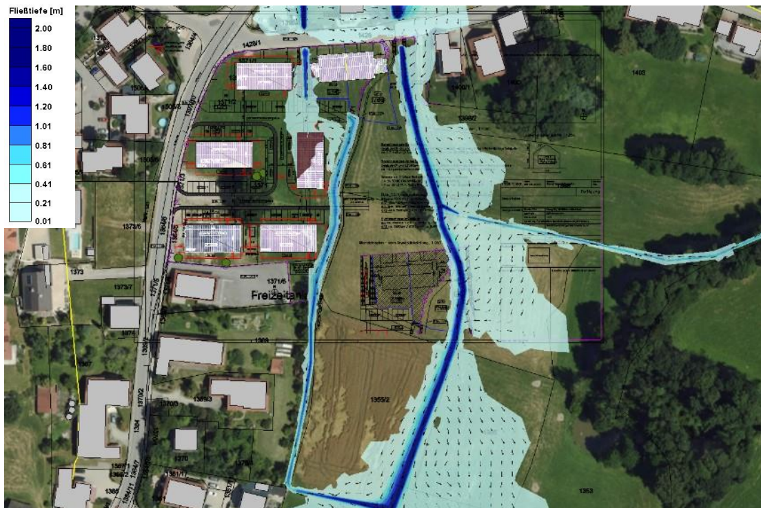
Abbildung 6.4: Abflusssituation im Planungszustand, HQ 100 – Detailansicht Bauvorhaben
